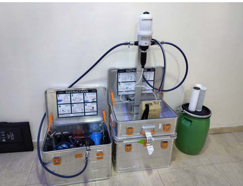
Eine der Water Purification Units (WPUs), die CADUS nach Port Sudan gebracht hat. Vor der Übergabe an lokale WASH-Partnerorganisationen wurde die Anlage in der Unterkunft aufgebaut und getestet.
